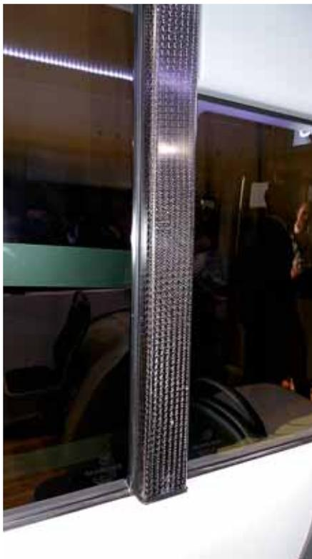
Beim Ebusco 3.0 hat man mit Elementen gearbeitet, die aus der Flugzeugtechnik stammen. Zur Erhöhung der Steifigkeit bestehen die tragenden Teile des Gerippes aus extrem widerstandsfähigen Kohlefasern.
