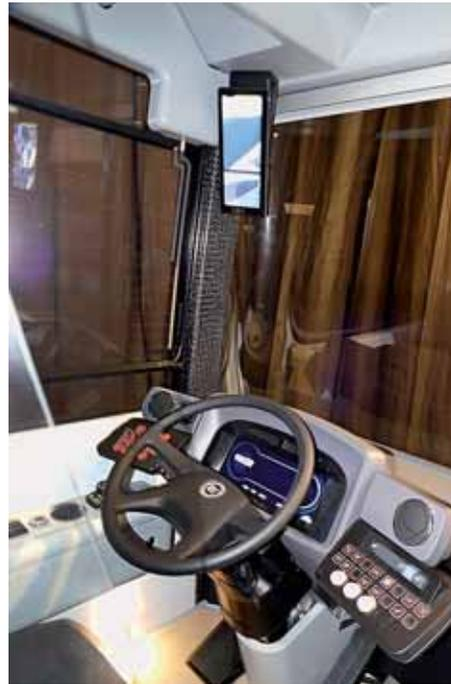
Innovativ wie der neue Elektrobus ist auch die Technik, so hat man sich des neuen modularen Fahrerarbeitsplatzes von Continental bedient. Auch ein Spiegeleratzsystem ist bei einem solchen Zukunftsbus fast schon State of the Art.
