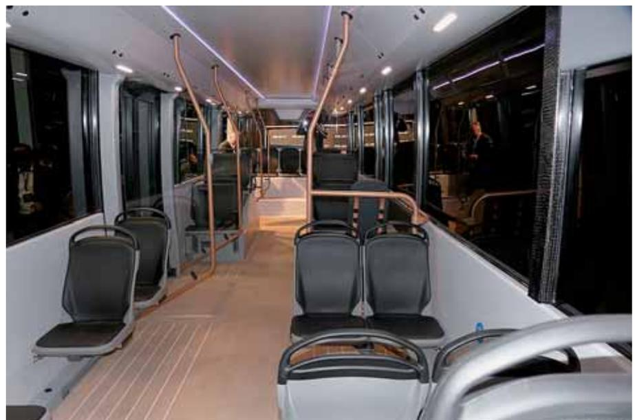
Der besondere Reiz des Ebusco 3.0 ist der podestfreie Innenraum mit großen Stehflächen, so ergibt sich eine maximale Passagierzahl von 95 Personen. Zwischen den Radkästen beträgt die Gangbreite 900 mm. Fluoreszierende Streifen im Boden sollen den Fahrgast leiten. Sie benötigen keine zusätzliche Energie, da sie sich bei Tageslicht aufladen.
